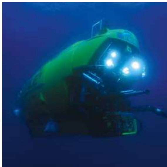
Le Nautilus de l'Ifremer, sous-marin habité qui peut plonger jusqu'à 6 000 mètres de profondeur avec trois personnes à bord. / Ifremer's Nautilus , a submarine that can dive to a depth of 6,000 meters with three people on board.
