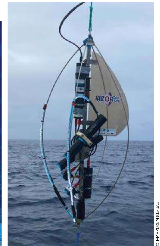
▲ L'Azor drift-cam prête à être mise en œuvre. Azor drift-cam ready to be deployed.
