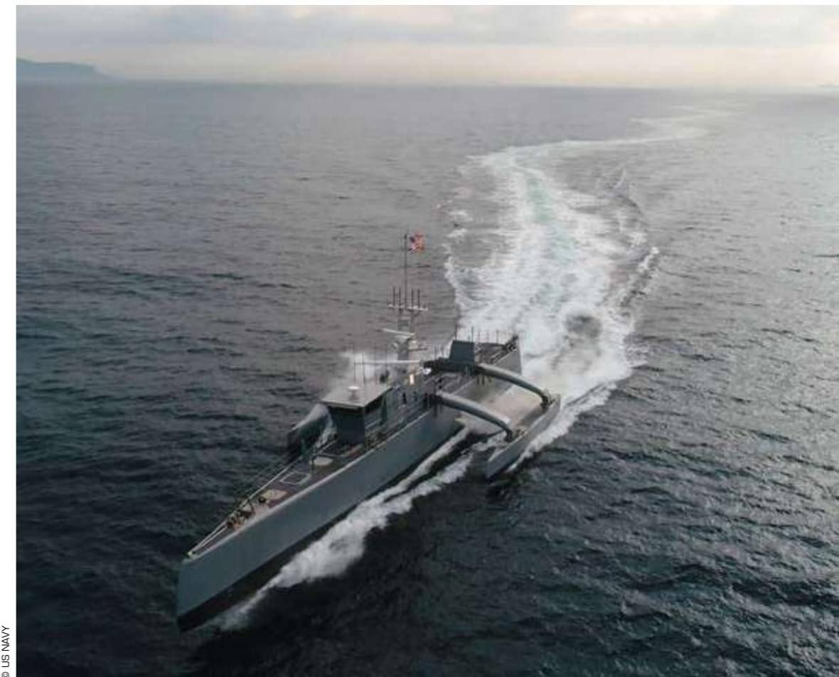
A gauche, les navires robotisés de la société Ocean Infinity dédiés à de nombreux usages civils. A droite, le Sea Hunter, démonstrateur de l'Agence de recherche du ministère de la défense américain, optimisé pour la détection anti sous-marine, qui a réalisé, en 2019, un aller-retour en autonomie entre San Diego et Hawaï.
