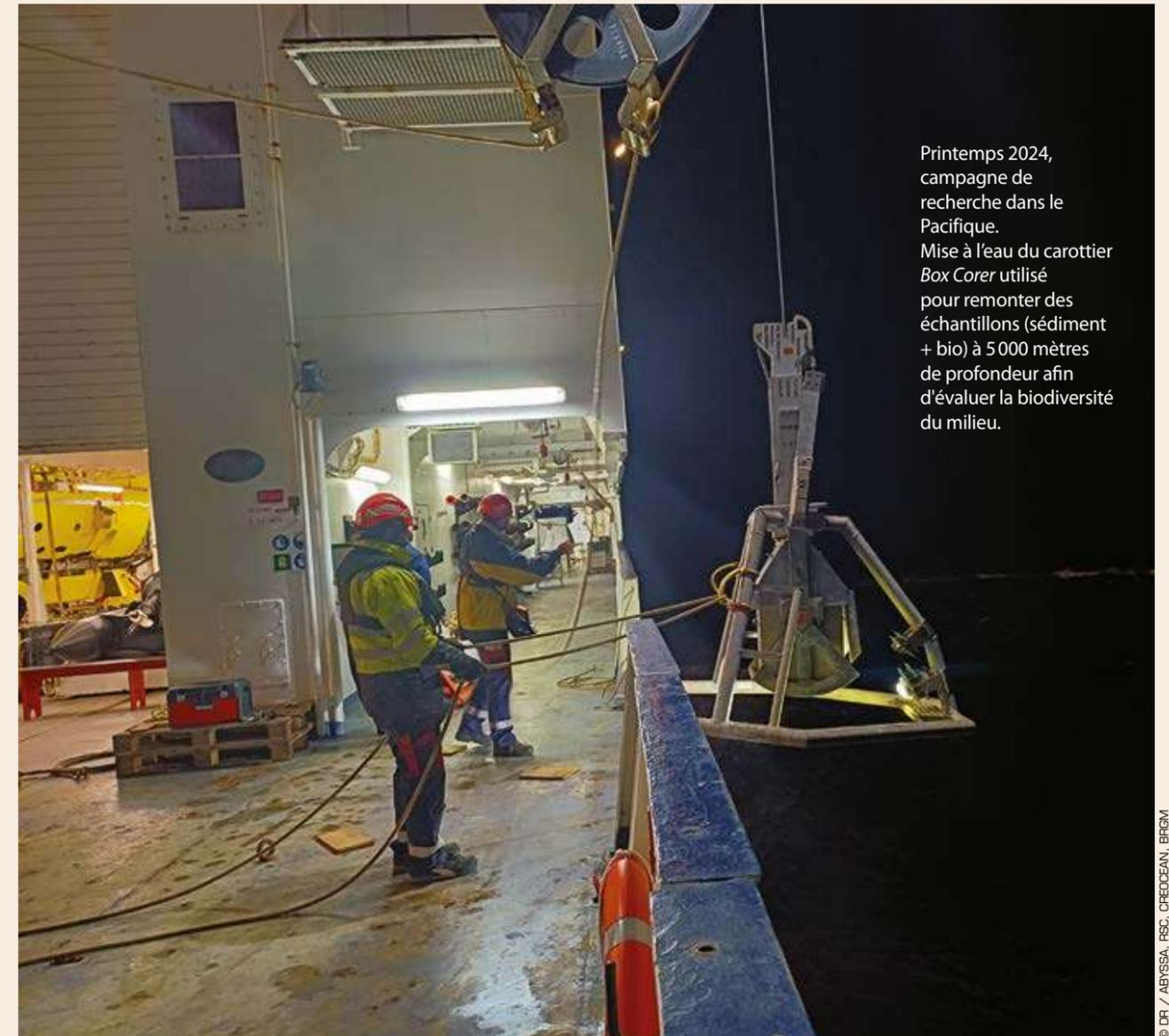
Printemps 2024, campagne de recherche dans le Pacifique. Mise à l'eau du carottier Box Corer utilisé pour remonter des échantillons (sédiment + bio) à 5 000 mètres de profondeur afin d'évaluer la biodiversité du milieu.
