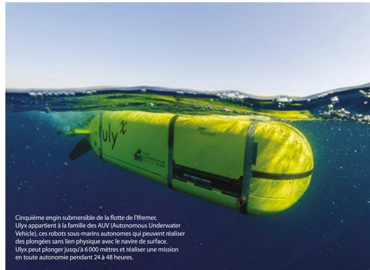
Cinquième engin submersible de la flotte de l'Ifremer, Ulyx appartient à la famille des AUV (Autonomous Underwater Vehicle), ces robots sous-marins autonomes qui peuvent réaliser des plongées sans lien physique avec le navire de surface. Ulyx peut plonger jusqu'à 6 000 mètres et réaliser une mission en toute autonomie pendant 24 à 48 heures.
