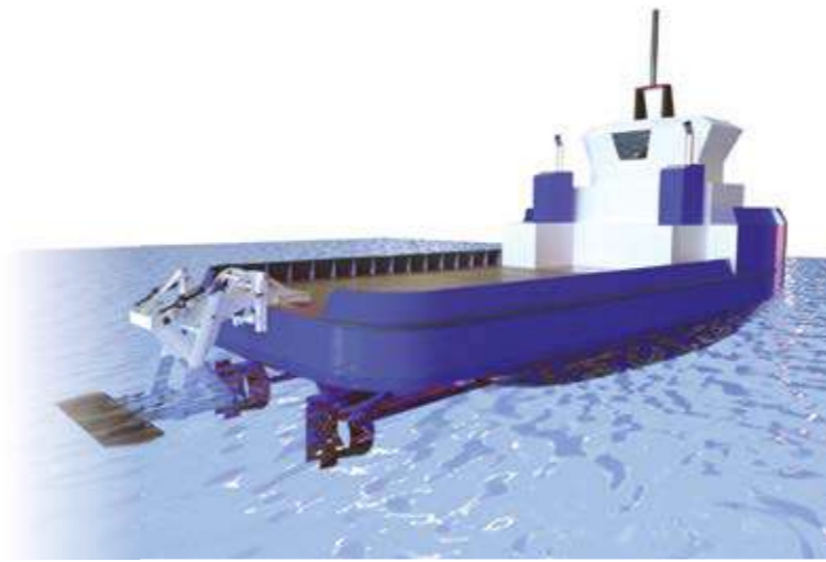
Bluefins développe une technologie de propulsion des navires s'inspirant des nageoires de baleines.
