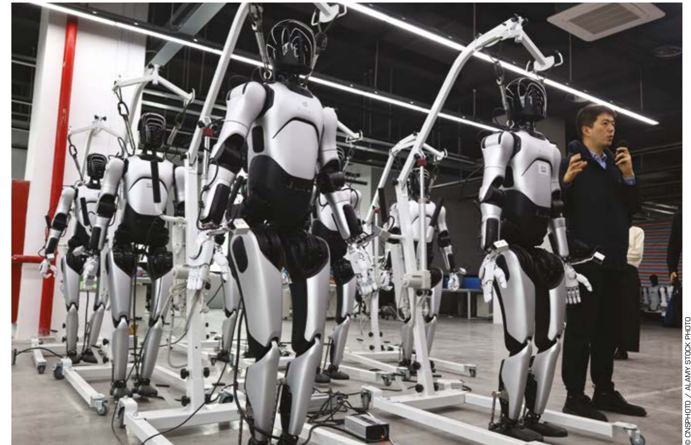
Formation de robots humanoïdes au Centre de formation en intelligence industrielle incarnée de l'Institut Tsinghua Zhejiang de technologie électronique flexible (IFET), à Jiaxing (province du Zhejiang), le 16 avril 2026. Les robots sont entraînés à partir de scénarios de travail et de données recueillies par des capteurs tactiles flexibles. L'objectif est de former la prochaine génération de robots autonomes destinés à l'industrie, une priorité de la stratégie chinoise en matière d'« intelligence incarnée ».
