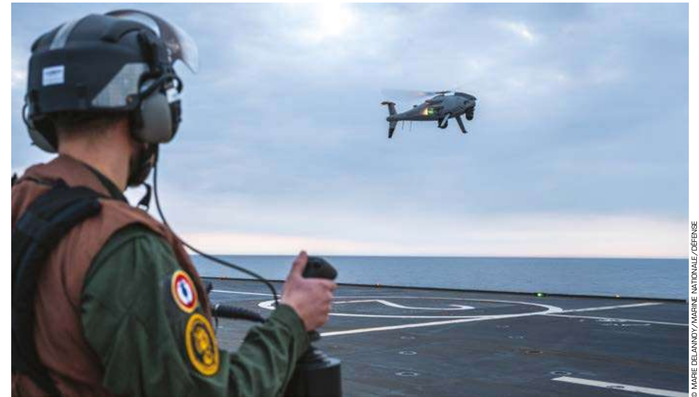
Utilisation d'un drone hélicoptère Camcopter S-100 lors de l'exercice amphibie Dragoon Fury 2025. Conçu par l'autrichien Schiebel, le S-100 décolle à la verticale, emporte jusqu'à 50 kg de capteurs et tient plus de six heures en vol avec 34 kg de charge. /A Camcopter S-100 rotary-wing drone in action during the amphibious exercise Dragoon Fury 2025. Designed by Austria's Schiebel, the S100 takes off vertically, carries up to 50 kg of sensors and can fly for more than six hours with a 34 kg payload.
