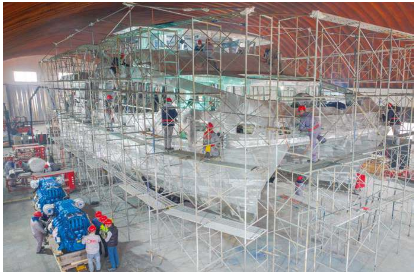
Vedette catamaran de 26 mètres (345 places), structure en aluminium encore apparente avant mise en peinture, en fin de chaudronnerie dans les ateliers d'ODC Marine à Dalian.
